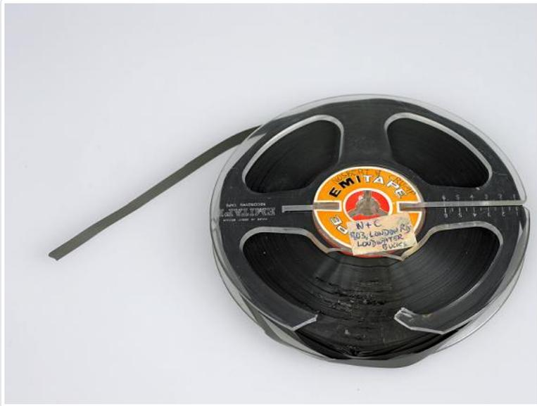
Figure 21 : Bobine de ruban magnétique audio endommagée. Dans ce cas particulier, la bobine et le ruban ont été endommagés simultanément. Une bobine cassée doit être remplacée, car elle rend le ruban non protégé plus sensible aux effets des forces physiques.
