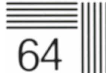
6. Cette même image de mire de définition montre une mise au point incorrecte
