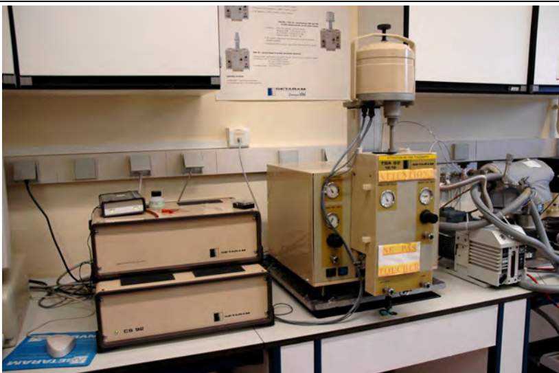
Figure 3 : Dispositif d'analyse thermogravimétrique alliant un spectromètre de masse LEYBOLD INFICON avec un système d'analyse thermique SETARAM TGA 92 (1975-200) © Université de Nantes
