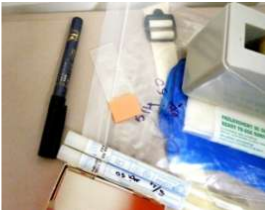
Prélèvement à l'écouvillon sec stérile
