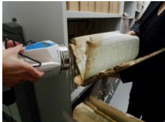
Prélèvement d'air autour d'un document moisissu
