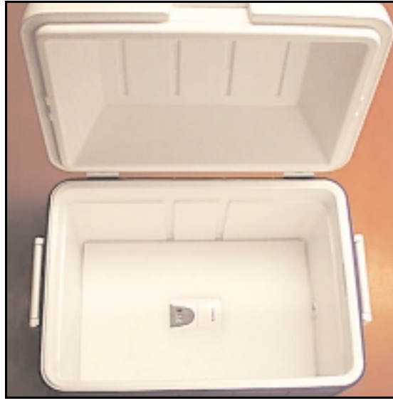
Figure 21. Chambre d'acclimatation équipée d'un thermomètre sans fil.
