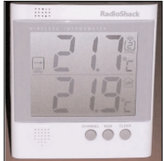
Figure 22. Récepteur du thermomètre.
