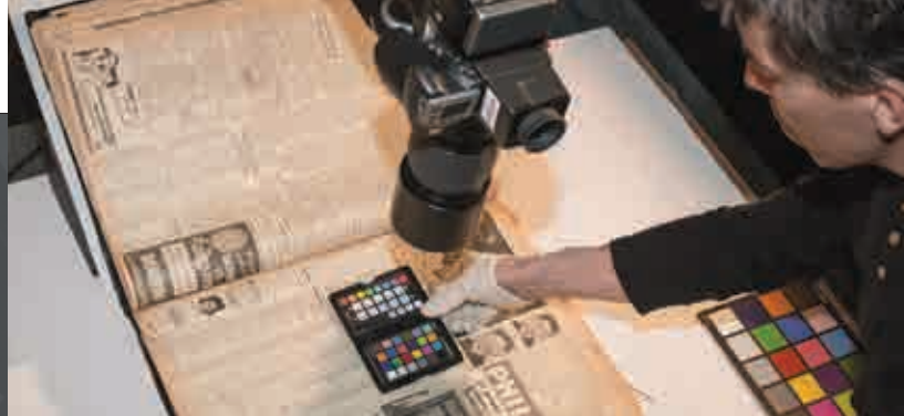
△ On utilise une charte de couleurs pour s'assurer de la qualité de la reproduction numérique.
