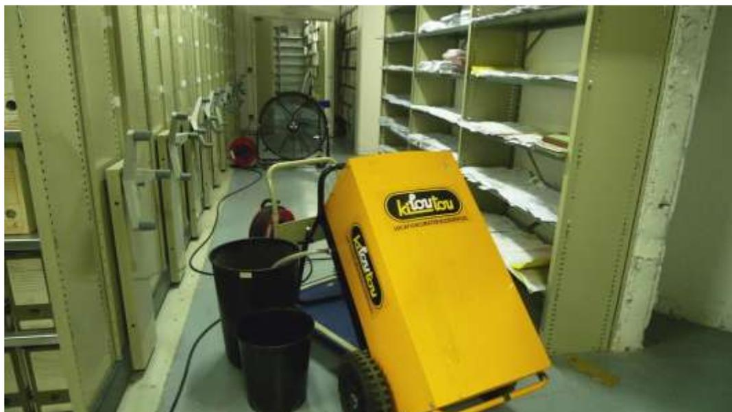
Le petit bac noir risque de provoquer des inondations, il a fallu incliner l'appareil pour évacuer l'eau dans le grand bac.
