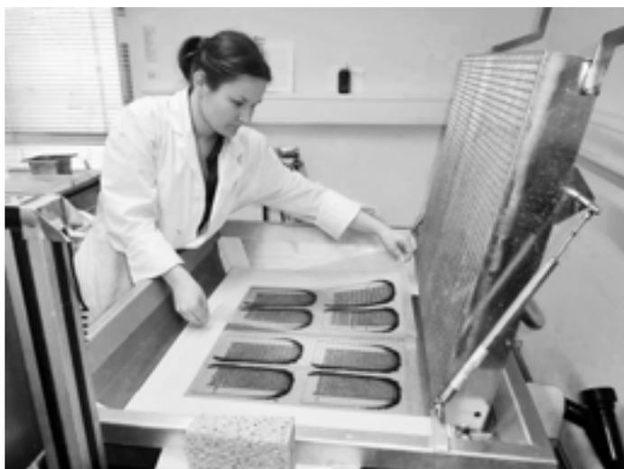
Im neuen Restaurierungsatelier in Ittigen bei Bern – Entnahme der angefaserten Buchseiten aus dem Anfasergeät.
