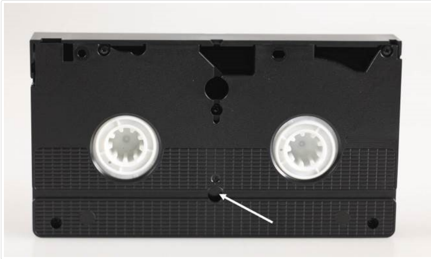
© Gouvernement du Canada, Institut canadien de conservation. ICC (Institut canadien de conservation) 124014-0019 Figure 4. Une pression du bouton indiqué par la flèche a pour effet de débloquer les moyeux et permet de vérifier que rien ne gêne leur rotation.
