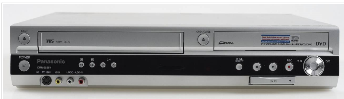
Figure 11. Combinaison d'un magnéscope et d'un enregistreur de DVD dans un seul appareil pouvant servir à créer des DVD à partir d'enregistrements VHS.
