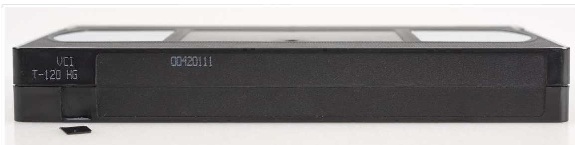
Figure 8. En haut : La languette de protection contre l'écriture indiquée par la flèche se trouve sur le bord supérieur de toutes les cassettes VHS. En bas : Il faut briser la languette pour empêcher l'effacement accidentel de l'enregistrement.
