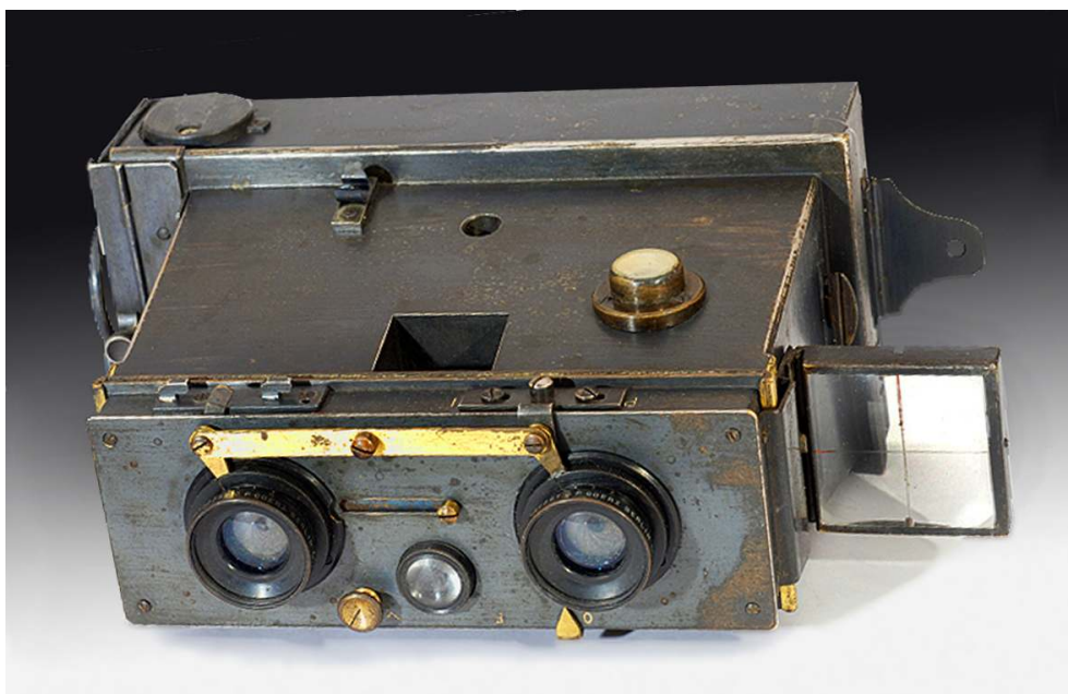
Véroscop Jules Richard, appareil construit tout en métal, pesant 980 gr, pouvant contenir 12 plaques 45 X 107 m/m. La particularité de cet appareil est d'être équipé de deux châssis : un pour la prise de vue, l'autre pour regarder les positifs. Son prix était à l'époque de 175 à 200 francs. © Centre Image Lorraine.
